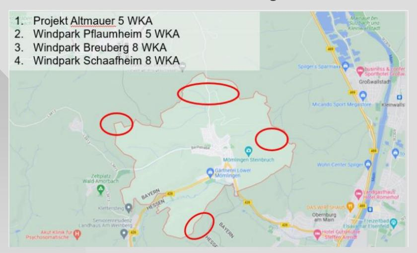
Es besteht ein Potential von 26 Anlagen, die bei ca. 150 m Nabenhöhe und 200 m Rotordurchmesser ca. 26 x 14.000.000 kWh/Jahr 364 MWh/Jahr produzieren könnten.
